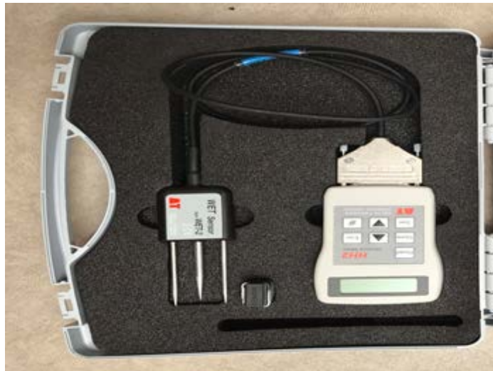
Slika 2. Senzor za mjerenje vlažnosti tla u zaštićenom prostoru
